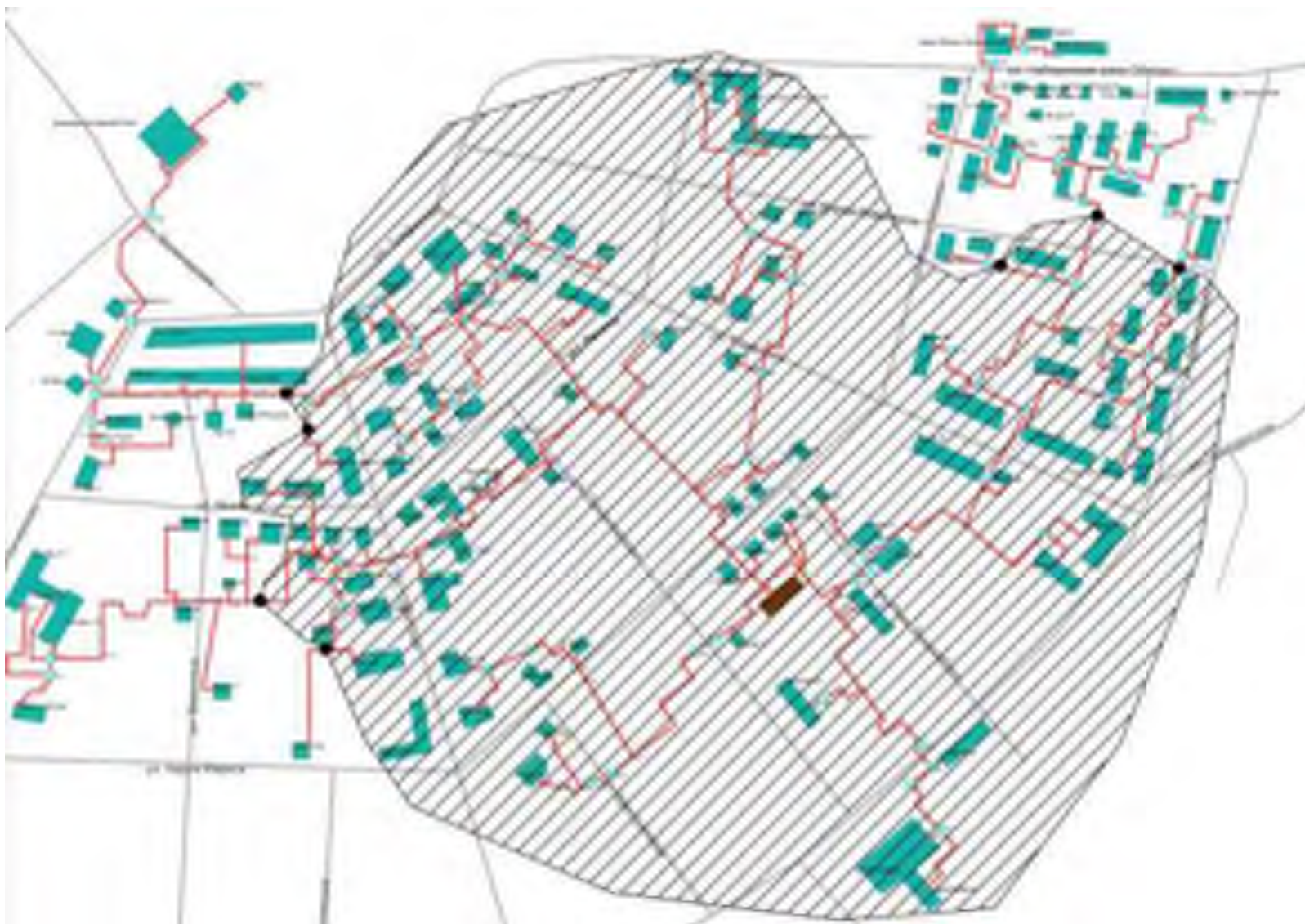
Рис. 6.1 Зона эффективного теплоснабжения для Центральной котельной
